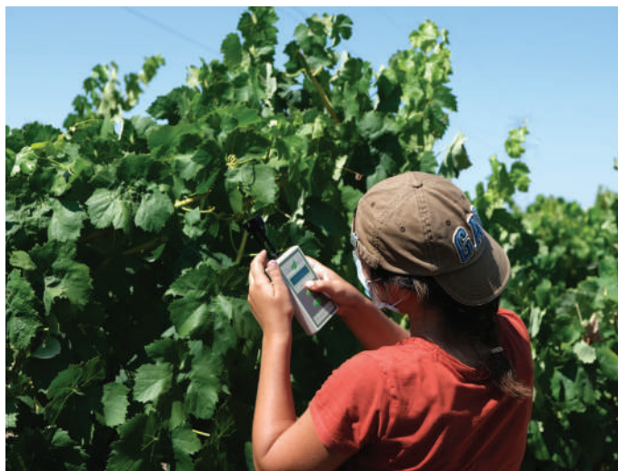
Medição do teor de clorofilas, que fornece uma indicação indireta do vigor da planta
